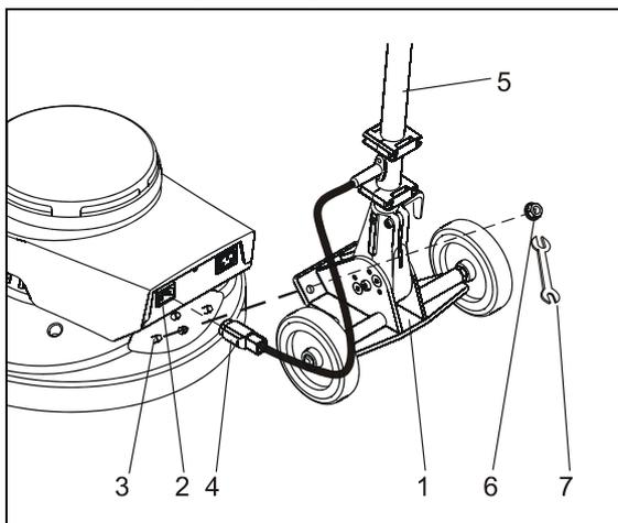
Abb. 5: Führungsstange montieren
