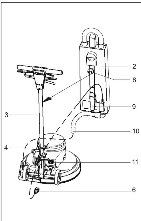
Abb. 12: Saugbehälter montieren
