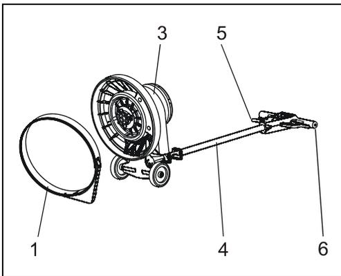
Abb. 10: Absaugung montieren
