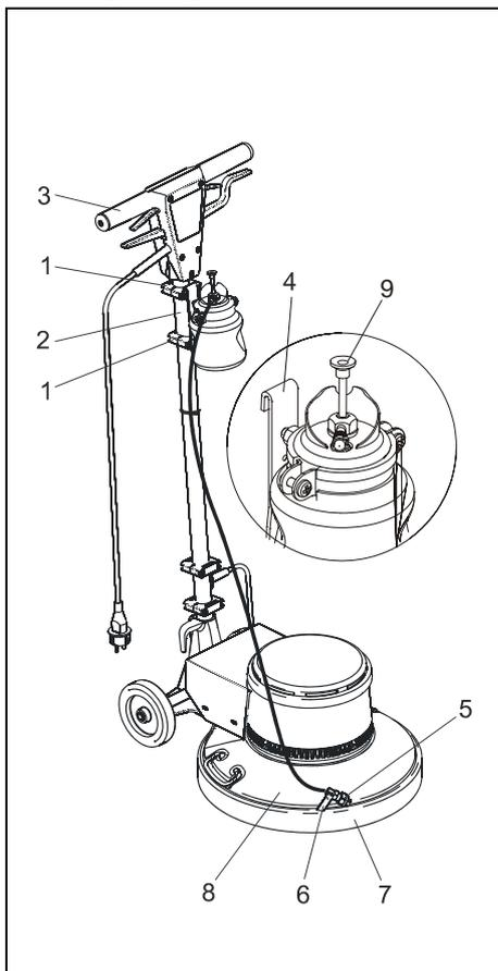
Abb. 7: Sprühgerät montieren
